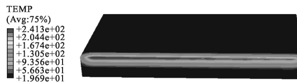
(d) 焊接速度为 80 mm/s (d) Welding speed=80 mm/s
