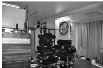
图 7 主镜组件面形测试实验现场
