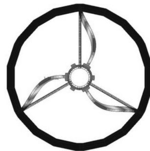
图 10 次镜支撑结构一阶振型图
