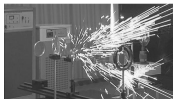
图 14 复合激光烧蚀铁板瞬间
