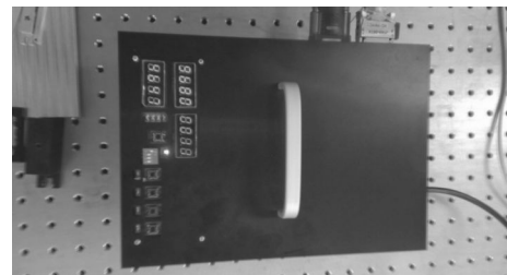
图 10 遥控遥测系统控制激光器电源和激光器以 1 Hz 频率出光图(计数 11 次)
