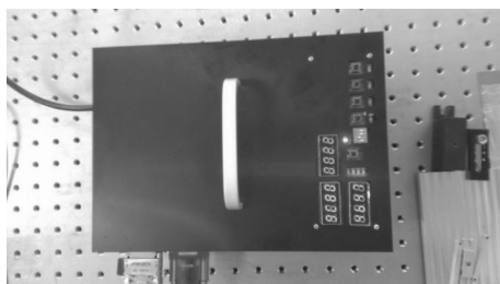
图 11 遥控遥测系统控制激光器电源和激光器以 2 Hz 频率出光图(计数 22 次)
