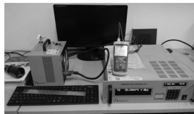
图 3 热像仪定标实验设备
