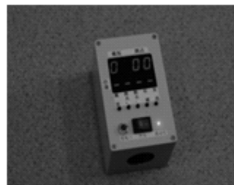
图 3 CCD 激光光斑接收器
