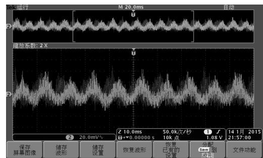
图 13 微弱可见光条件下的电路输出
