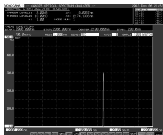
图 7 2.1 μm 激光波长示意图
