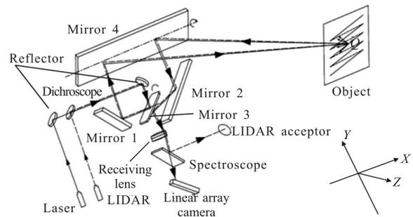
图1 融合 LIDAR 的同步扫描原理图
