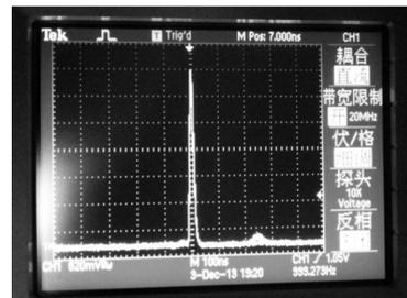
图 6 APD 探测到脉冲信号的峰值图
