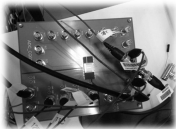
图 8 ADC 芯片封装和测试
