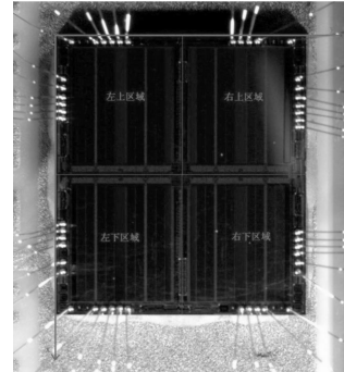
图 8 坐标设定和测试区域划分
