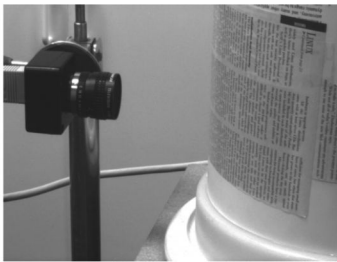
图 8 像移模拟装置图
