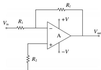
图5 反相比例运算放大电路
