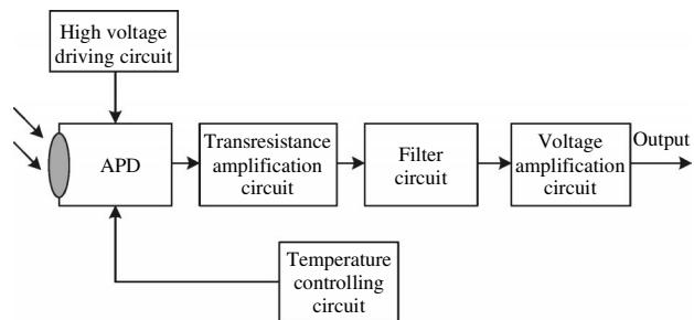
图 1 室内可见光通信接收子系统原理框图
