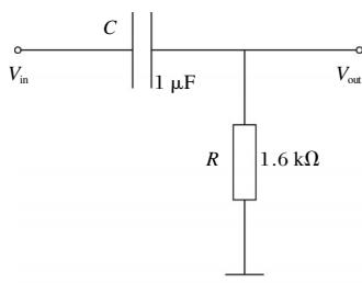
图3 一阶无源高通滤波器
