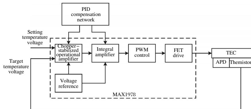
图 6 基于 MAX1978 控制探测器温度的原理框图
