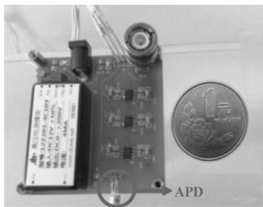
图 7 探测器的放大滤波温控组件
