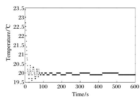
图 8 探测器温度的实测曲线
