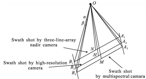
图1 高分辨、多光谱相机与三线阵正视相机夹角几何模型
