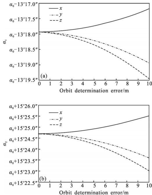
图 3 定轨误差对高分辨与三线阵正视相机夹角  $\alpha$  的影响
