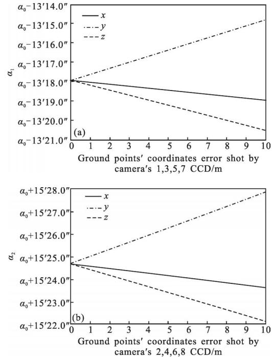
图 5 高分辨相机对应地面控制点精度对夹角  $\alpha$  的影响
