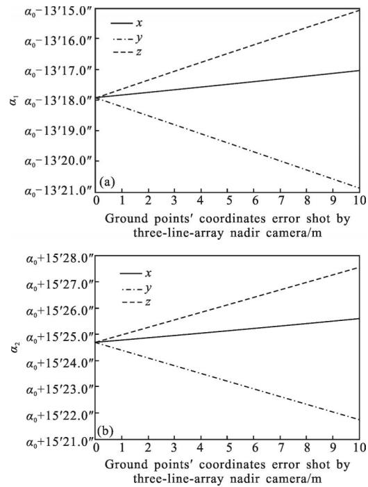
图 4 三线阵正视相机对应地面控制点精度对夹角  $\alpha$  的影响
