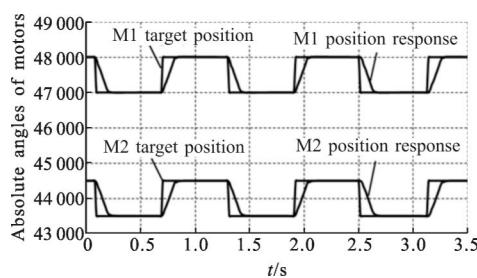
图 8 力矩电机位置响应曲线
