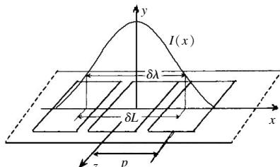
图2 阵列探测器获取光谱示意图
