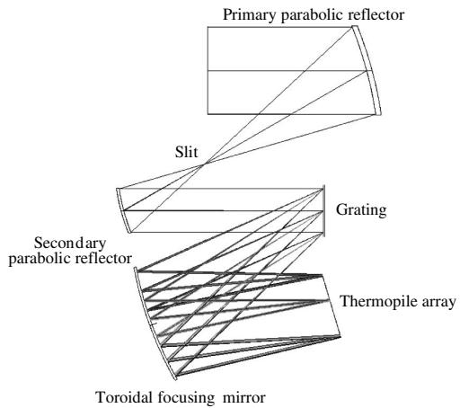
图 7 优化后的中红外平面光栅光谱仪光学系统
