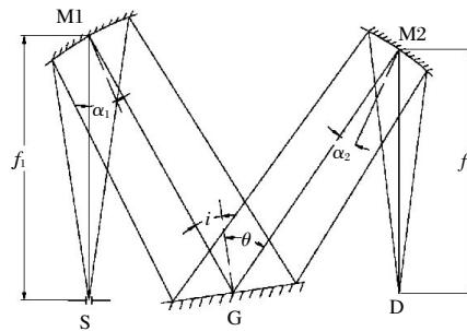
图 1 Czerny-Turner 结构示意图
