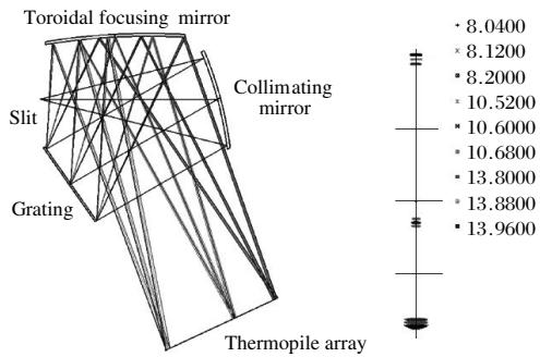
图 5 交叉 Czerny-Turner 结构和部分波长点阵图
