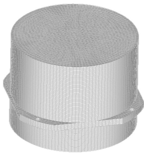
图 2 光纤陀螺组合的有限元模型
