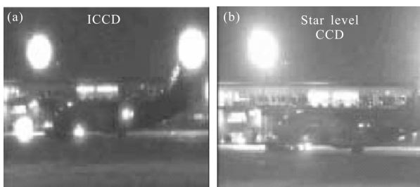
图 2 美国 ITT 公司星光级 CCD 和普通 ICCD 的夜视成像对比 Fig.2 Comparison of night vision imaging between ICCD and the ITT company's star level CCD
