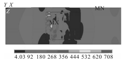
(c) t=300 s 时层间交错扫描残余应力分布云图
