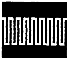
图 1 MSM 结构示意图
