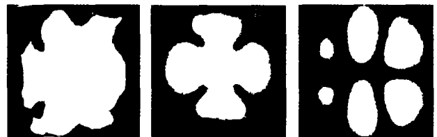
图 12 总衍射强度照片 图 13 原偏振光方向的衍射强度照片 图 14 正交偏振光方向分量的衍射强度照片
