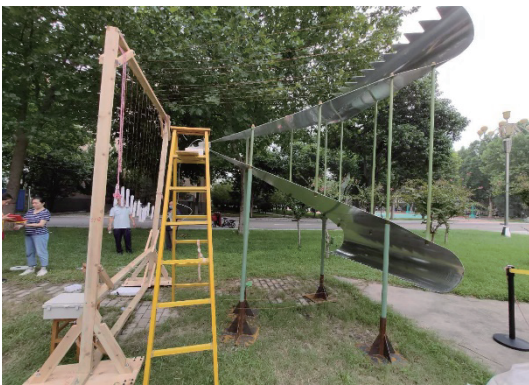
Fig. 16 Electromagnetic pulse radiation test 图 16 电磁脉冲辐射试验
