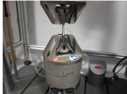
Fig. 6 Clamping mode of test pieces 图 6 试验件装夹方式
