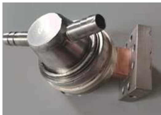
Fig. 12 New water load 图12 新水负载实物图
