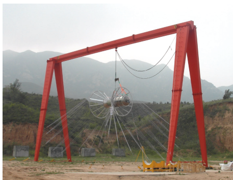
Fig. 1 Photo of the EMP simulator 图1 电磁脉冲模拟器实物照片
