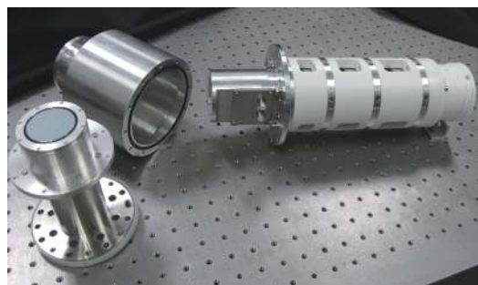
Fig. 2 Coaxial electrode double-focus streak tube 图 2 同轴电极双聚焦扫描管
