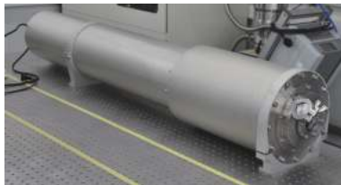
Fig. 7 Picture of X-ray femtosecond streak camera 图 7 工程化 X 射线飞秒条纹相机
