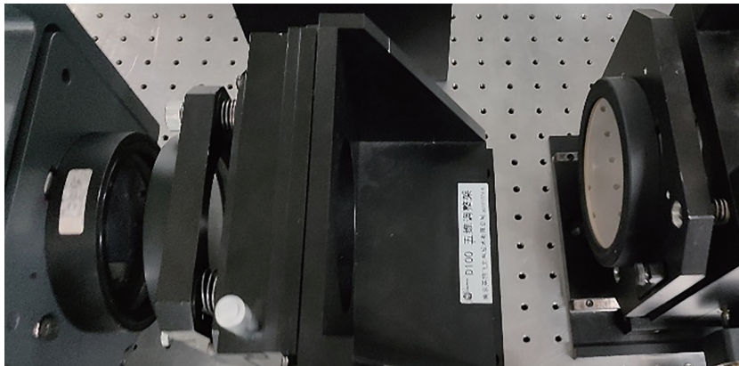
图6 透射法测量折射率均匀性实验
