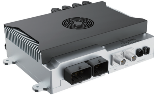
图 10 MIIIVII APEX AD10 嵌入式 AI 计算平台 Fig. 10 Embedded AI computing platform MIIIVII APEX AD10
