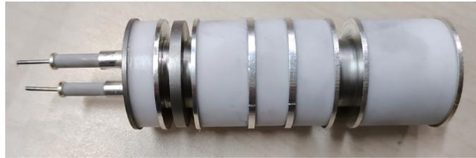
图3 X射线调制管实物
