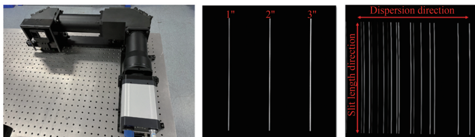
图5 长缝光谱仪的整体照片和长缝光谱图像
