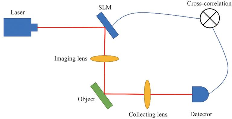
图1 计算关联成像光路图
