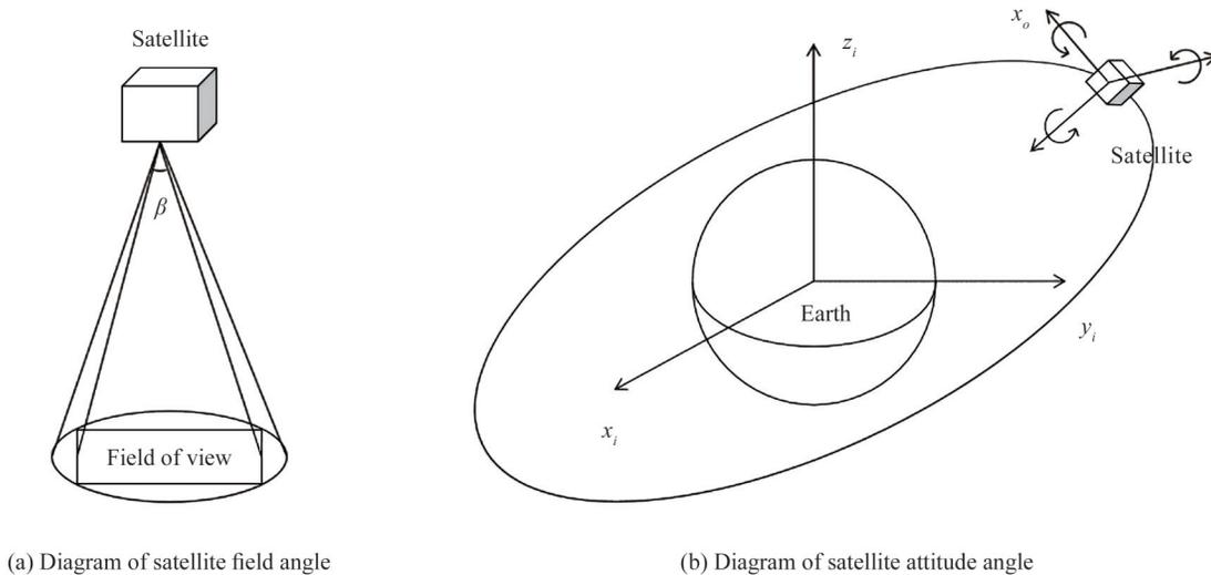
图 2 卫星探测地球示意图
