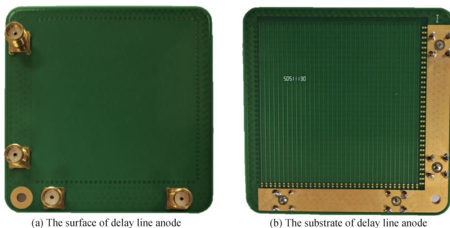
图5 延迟线阳极结构
