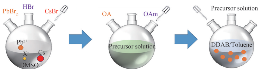
图1 室温过饱和和析晶法合成CsPbBr 3 钙钛矿量子点示意图
