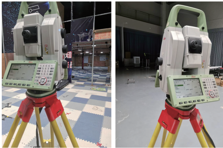
图18 Vicon/度量系统外参标定实验
