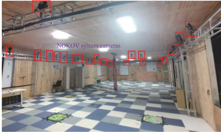
图17 度量系统相机分布
