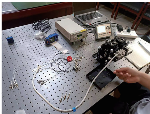
图6 4×4光纤式微透镜阵列光纤耦合效率测试
