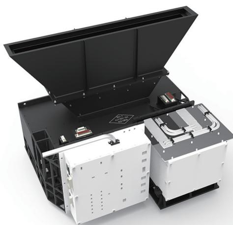
图 23 环境减灾二号 A、B 星可见-近红外、短波红外高光谱成像仪结构
