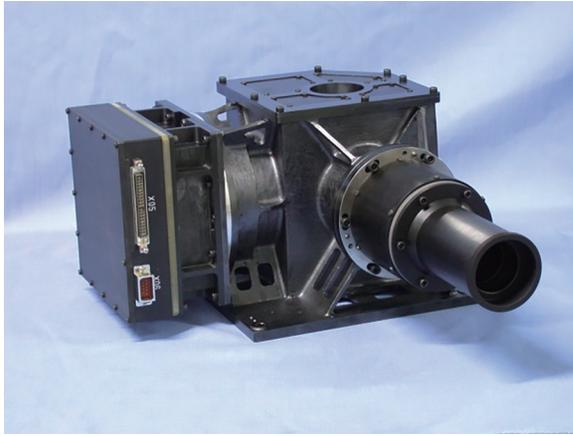
图12 “嫦娥一号”搭载的干涉光谱成像仪结构实物
