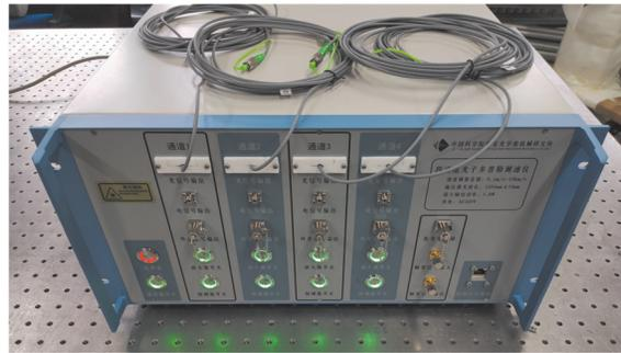
图2 内弹道试验使用的PDV装置
