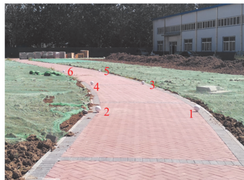
图 7 靶标球布设 Fig. 7 Target ball layout
