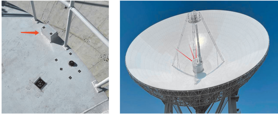
图5 武清70 m天线面板形变监测示意
