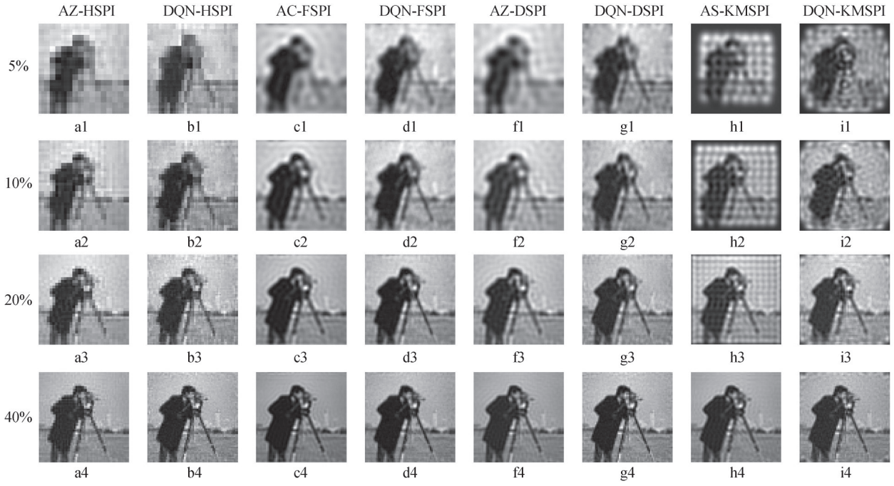
图3 不同采样率和降采样方式下的重建“Cameraman”图像
