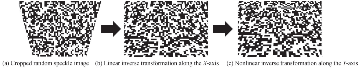
图9 梯形畸变矫正算法中间过程
