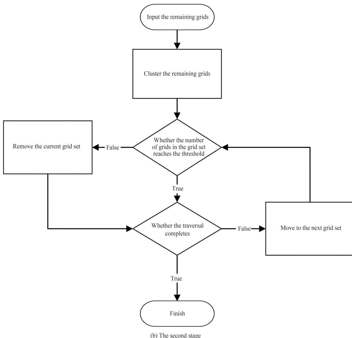
图3 基于非线性函数的阈值自适应去噪算法流程图
