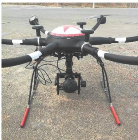
图4 搭载曲面仿生复眼成像系统的无人机
