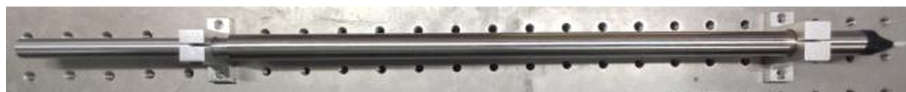
图 3 光纤光栅位移传感器实物图 Fig. 3 Physical image of FBG displacement sensor
