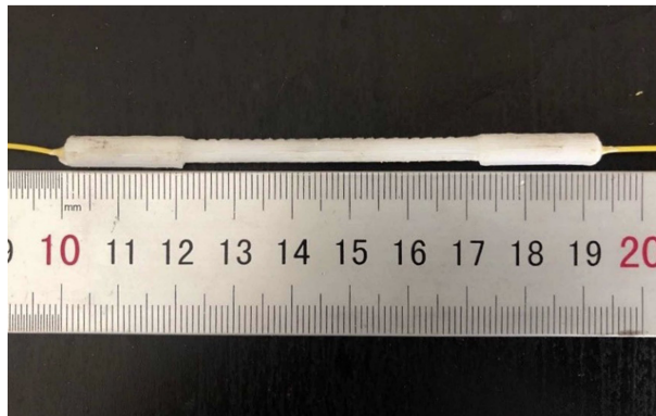
图2 夹持式3D打印光纤光栅应变传感器实物
