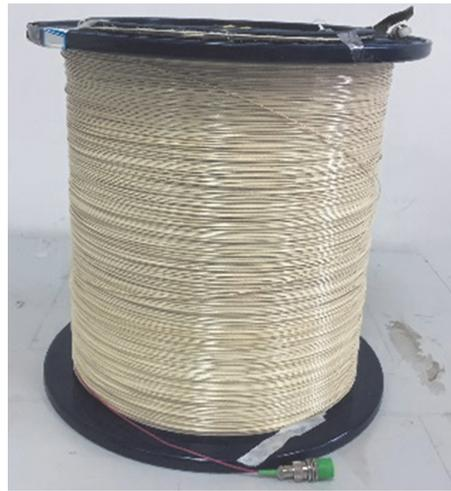
图7 直径0.9 mm的309元液晶树脂二次涂覆WFBG阵列
