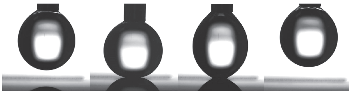
图 6 水滴无法落在不锈钢样品上的过程
