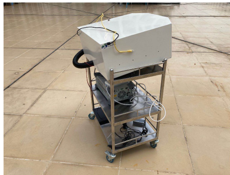
图9 搭建的连续相干测风激光雷达系统
