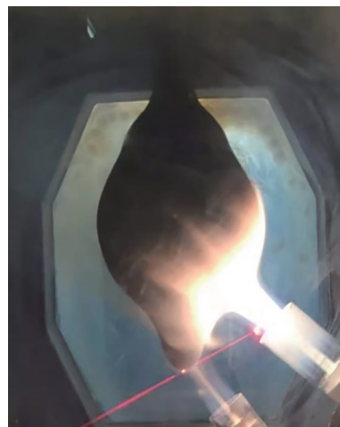
图6 VAD沉积过程 Fig. 6 VAD deposition process
